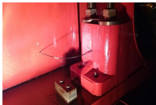
Gambar 3. Letak Sensor Vibrasi Pada Plummer Block Bearing
