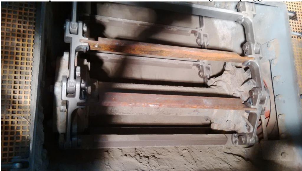
Gambar 8 Penggantian scrapper yang telah dimodifikasi
