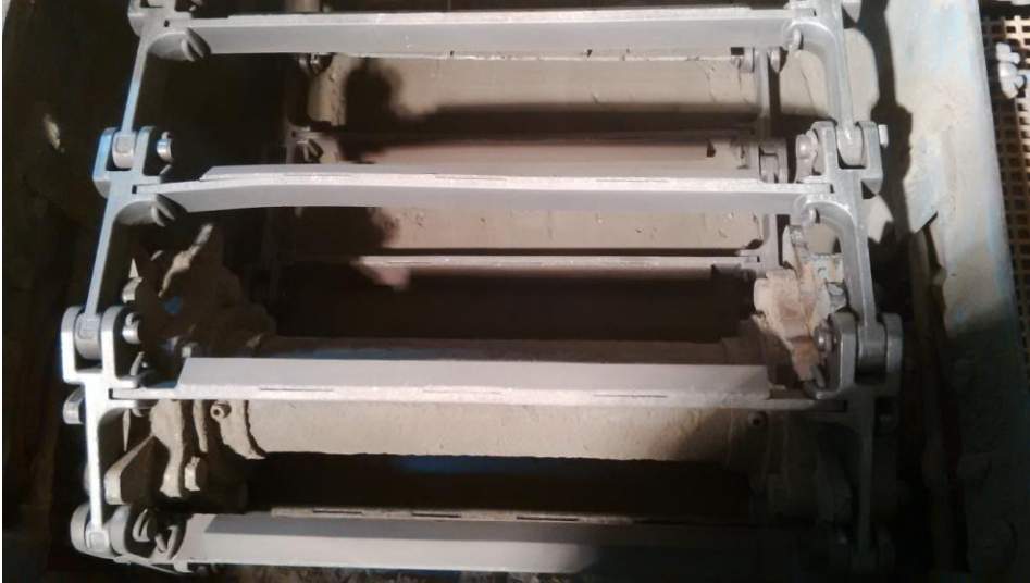
Gambar 7 Bengkoknya scrapper lama
