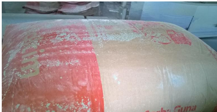
Gambar 5 Kondisi kantong semen sebelum dilakukan proses modifikasi
