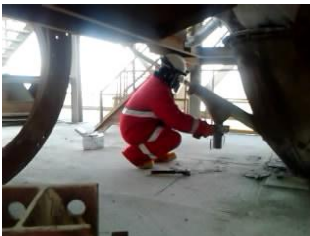
Gambar1. Proses pengambilan sampel Hot Meal secara manual pada Preheater lantai 6 Kalsiner ILC dan SLC
