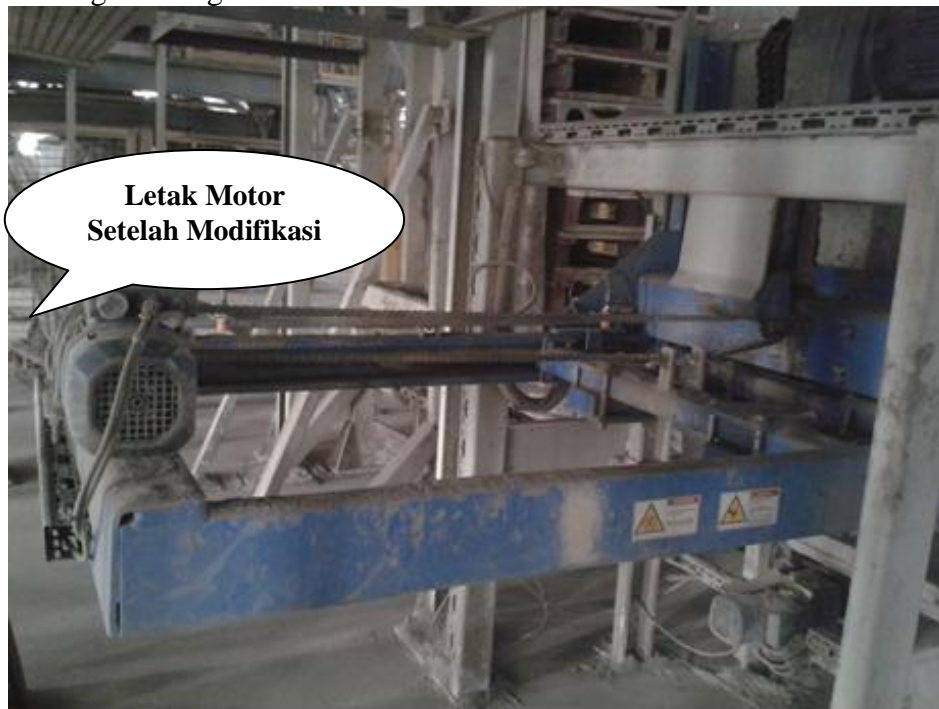
Gambar 4. Posisi Motor Fork Separator Setelah Modifikasi
