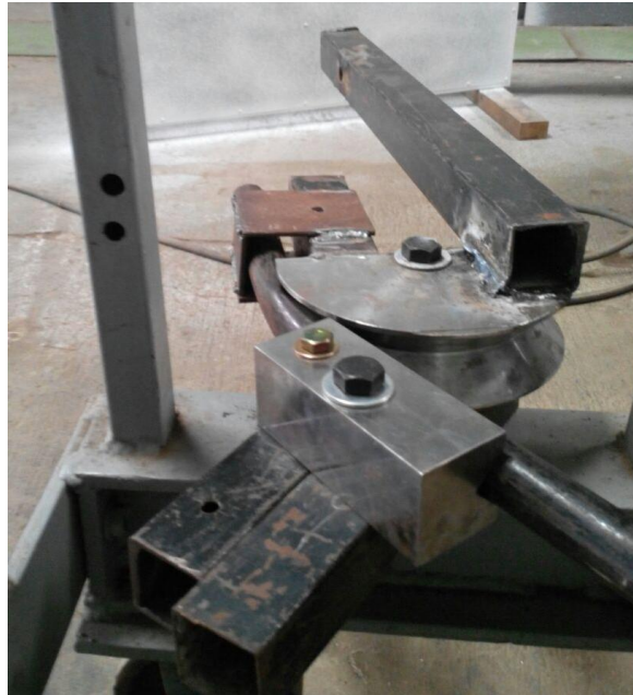
Gambar 11 - Proses Percobaan untuk membengkokan Pipa 1 [in]
