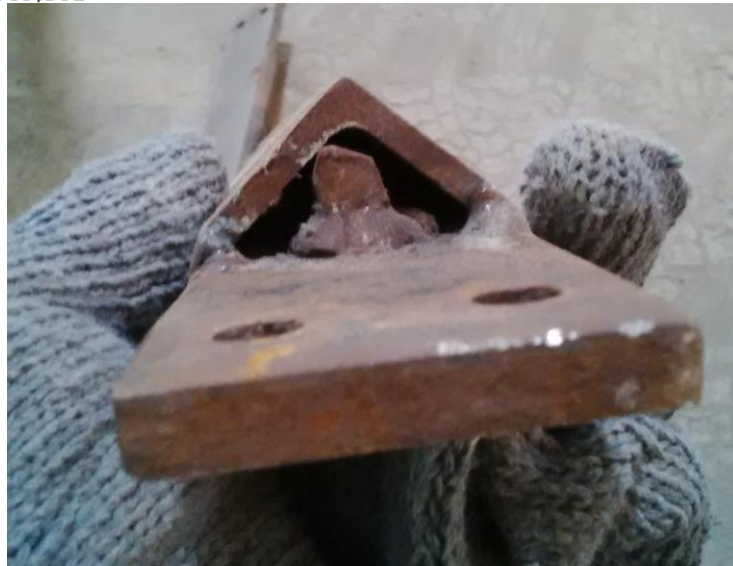
Gambar 6 Scrapper Chain Conveyor yang telah dimodifikasi.
