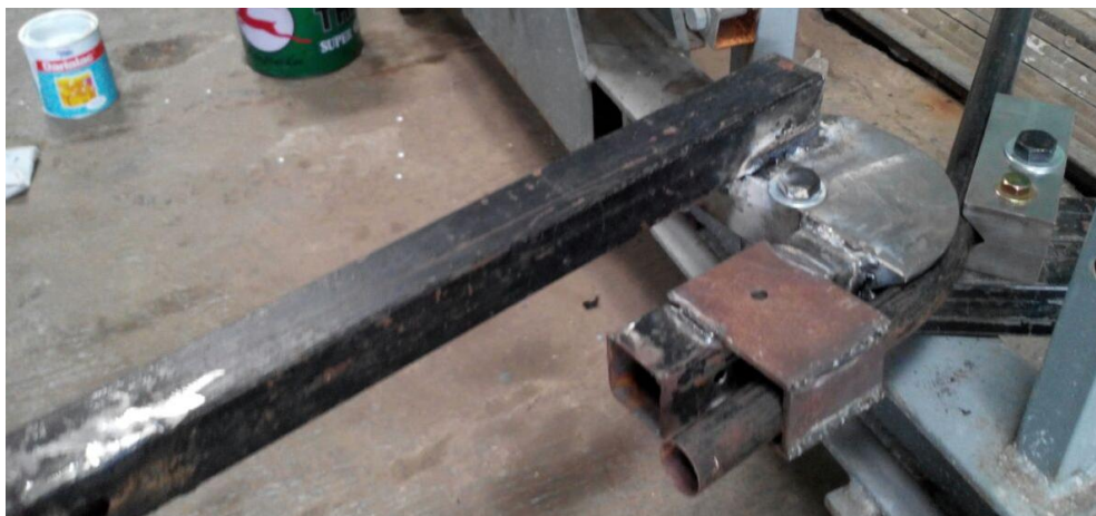
Gambar 12 - Percobaan Pembengkokan Pipa menggunakan profile V
